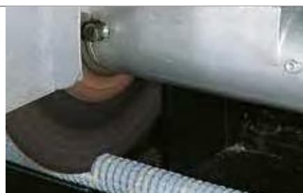
Mit geringem Druck durchtrennen Enden versäuern Cut through the conduit with low pressure clean ends
