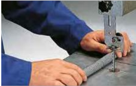
Schlauch im rechten Winkel zum Sägeblatt ansetzen Position conduit at right angles to band saw
