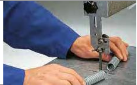
Sauberer Schnitt und gebrauchsfertige Schlauchenden Conduit ends are clean and ready for use
