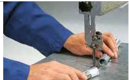
Saubere Trennung ohne Fasern durch die Umwicklung mit Metall-Klebeband Conduit ends are clean without splaying, due to adhesive tape binding
