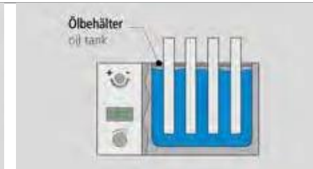
Temperaturprüfungen nach Flexa Norm 1034 Temperature tests acc. to Flexa norm 1034
